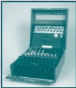
Enigma à 3 roues codeuses
